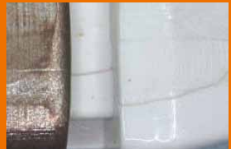
La punta blanca de plástico de un cúter lineal se ha separado un poco, y muestra una grieta y sangre y residuos de fluidos corporales.
