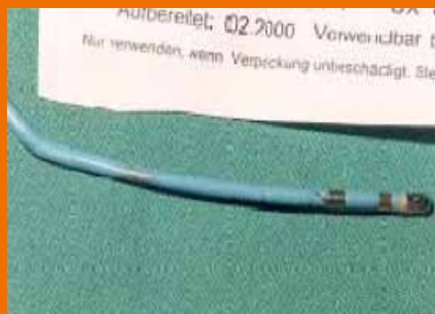
Catéter EP restaurado por un tercero que provocó una insuficiencia en una válvula cardíaca. Cuando los electrodos se separaron, la válvula cardíaca quedó bloqueada entre los electrodos.
