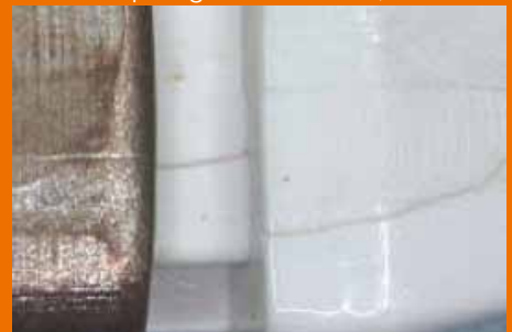
Die weiße Plastikspitze eines Linearmessers wurde leicht abgetrennt und legt einen Spalt sowie Rückstände von Blut und Körperflüssigkeit frei.
