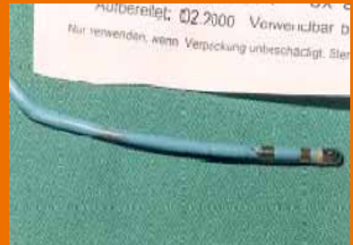
Ein wiederaufbereiteter EP-Katheter eines Drittanbieters, der zu einer unzureichenden Herzklappe führt. Durch die Trennung der Elektroden wurde die Herzklappe zwischen den Elektroden eingeschlossen.
