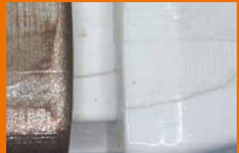
La pointe en plastique blanche d'un cutter linéaire s'est légèrement séparée et révèle une fissure, du sang et des résidus de fluides corporels.
