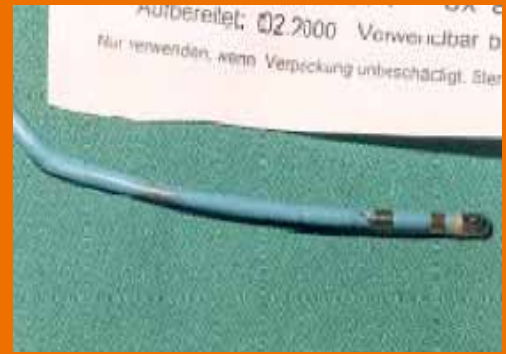
Un catetere EP ricondizionato da terzi può produrre una valvola cardiaca insufficiente. Quando gli elettrodi sono stati separati la valvola cardiaca è stata bloccata tra gli elettrodi.
